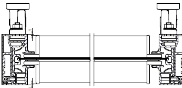
Montaż prowadnic z użyciem uchwytów (system ZIIIP120)
