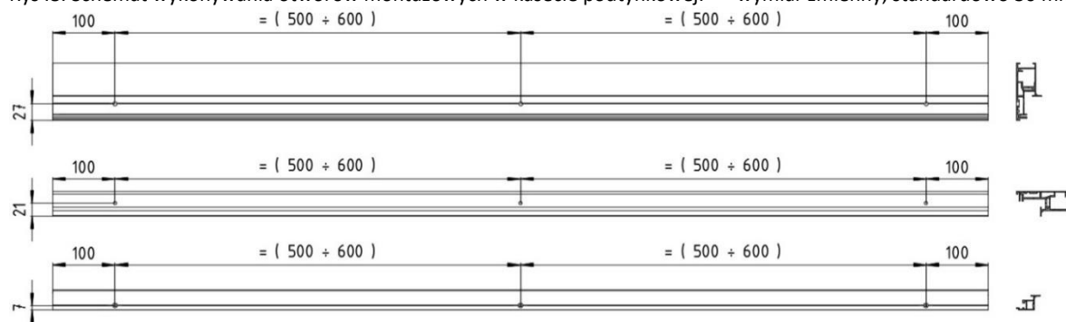
Rys. 9. Schemat wykonywania otworów montażowych w Profilu prowadnicy i profilu rewizji prowadnicy.
